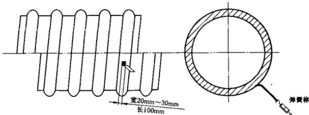
图 A.1 剥离强度测试示意图
