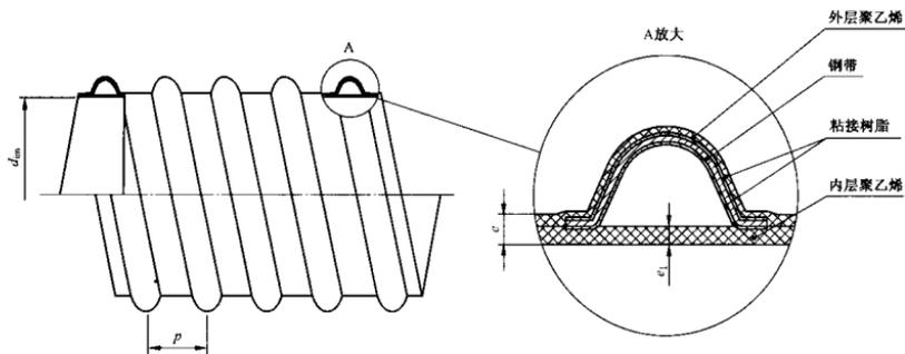
图 1 管材结构示意图
