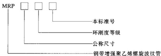
示例：公称内径为 800 mm，环刚度等级为 16 的钢带增强聚乙烯 (PE) 螺旋波纹管材标记为：
