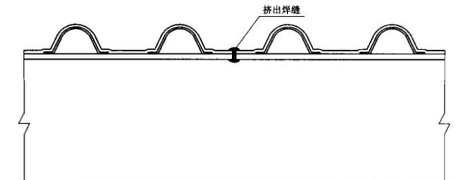
图 2 热熔挤出焊接连接示意图
